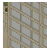
ใช้โครงสร้างไม้เทียมมารับแผ่นกระจกบางใส
